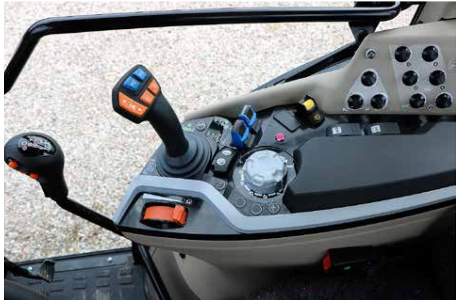
Desna krmilna konzola pri opremi Efficient z elektronsko regulacijo zadnjega hidravličnega dvigala, električnimi hidravličnimi krmilnimi ventili, križno krmilno ročico za te ventile, s stikali za izbiro smeri vožnje in vmesnih prestav (oranžne tipke).
