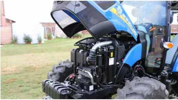
Kompaktni 2,9-litrski FTP motor, turbinsko polnjen in s hlajenjem sesalnega zraka. Za vzdrževanje na enostaven način odstranimo še stranski oblogi motorja.
