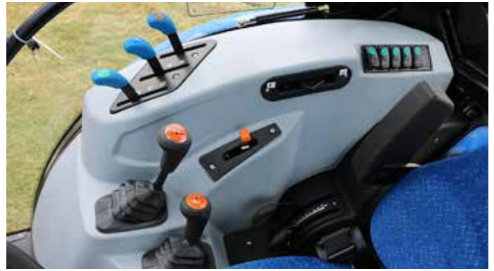
Na desni strani voznikovega sedeža so prestavni ročici, krmilne naprave hidravlike, ročni plin in stikala za luči.
